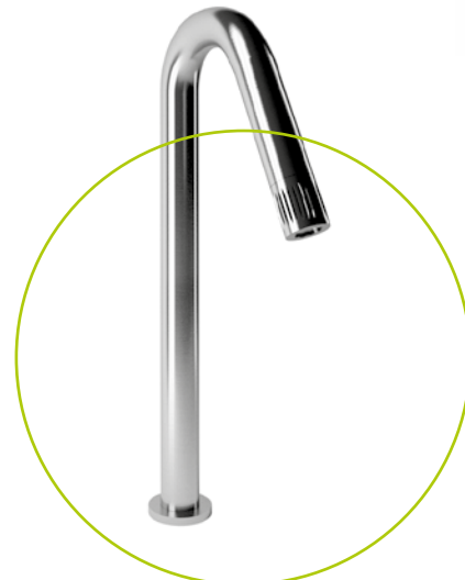
Cod. 70532 Miscelatore lavabo GIREVOLE (alto mm 346) in acciaio spazzolato 316 e cartuccia progressiva inclusa nella bocca. 316 Brushed stainless steel (346 mms. high) SWIVEL basin mixer with progressive cartridge placed in the spout
